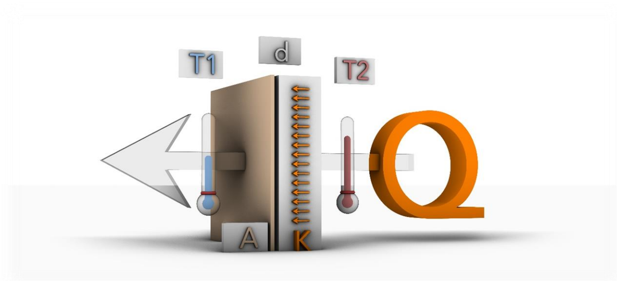
Figura 11 Concettualizzazione delle variabili in gioco nel processo di trasferimento termico per conduzione - Fonte: Candidato
